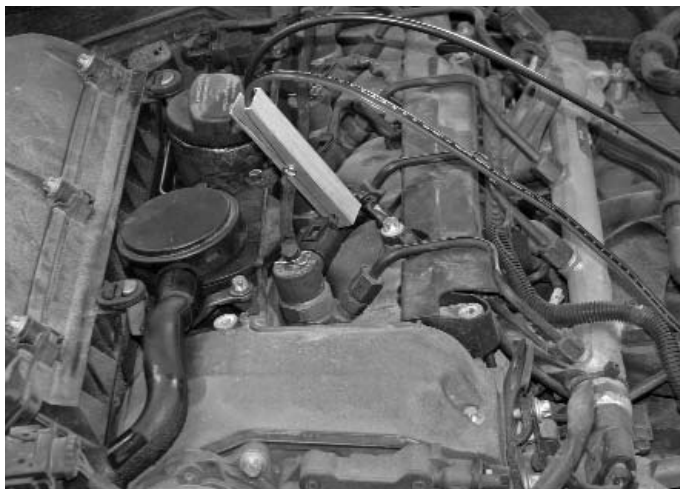
Фото 1. Подключение токовых клещей для получения графика тока, протекающего в цепи обмотки электромагнитного клапана форсунки дизельного двигателя с системой управления Bosch Common Rail.
