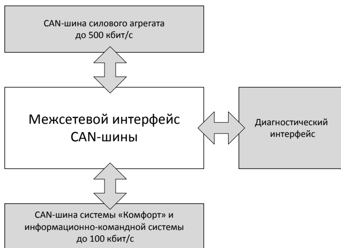
Рисунок 10. CAN-шина силового агрегата, CAN-шина «Комфорт» и CAN-шина информационно-командной системы
